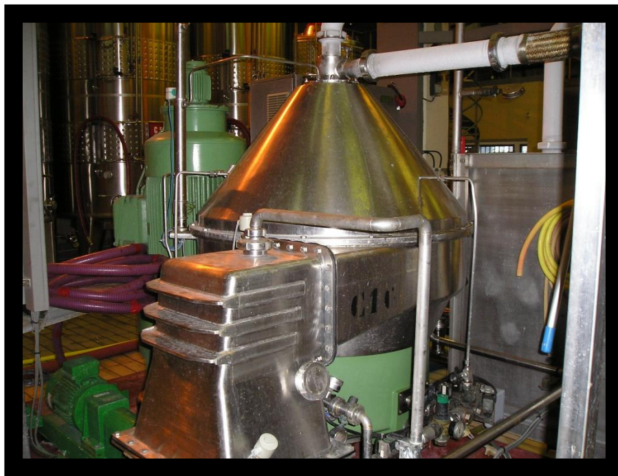
10. ábra: Nagy hatékonyságú, folyamatos működtetésű, tányéros szeparátor
