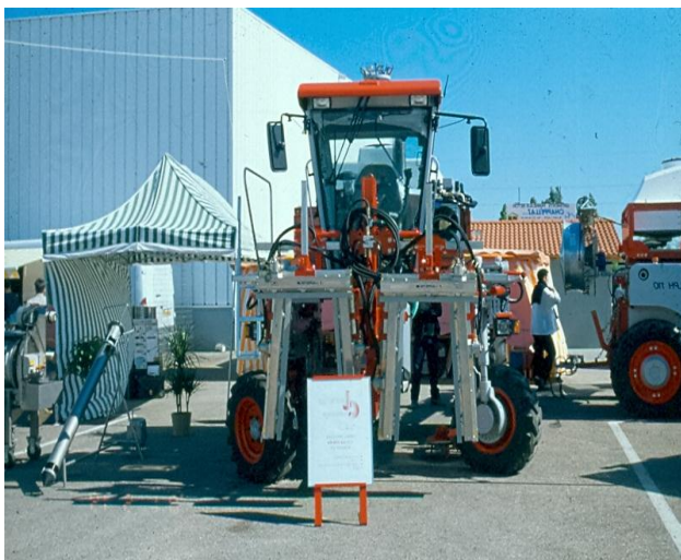
70. kép Szüretelőkombájn csonkázó adapterrel (saját felvétel)
