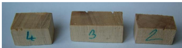
12.ábra SEM-os elemzéshez előkészített 'I-214' nyár minták
