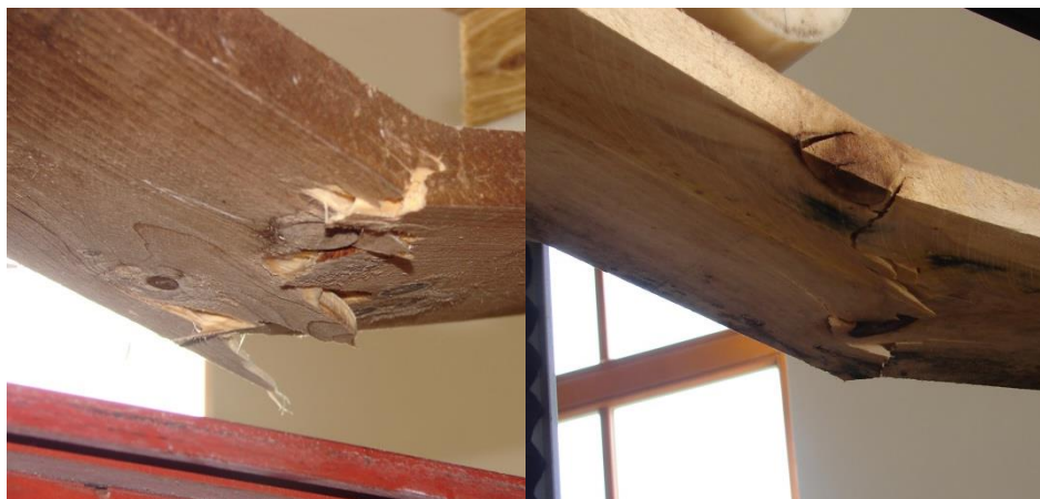
34.ábra 4 pontos hajlítószilárdsági tönkremenetel erdeifenyő (bal) és 'Pannonia' nyár (jobb) esetén
