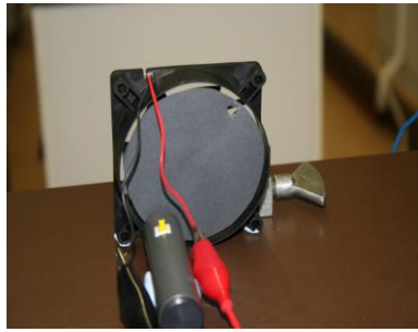
5. ábra. Ventilátorra ragasztott kartonlap kis lyukkal az oldalán. Így hangkártyához csatlakoztatott fotokapuvál is mérhető a periódusidő.
