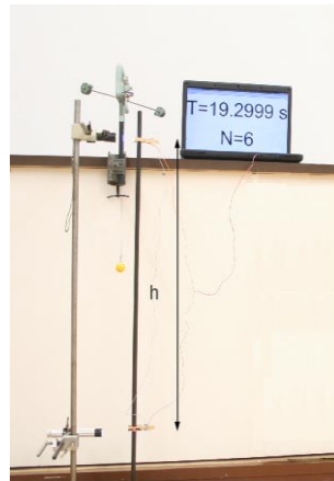
3. ábra. A forgómozgás dinamikai vizsgálatára a középiskolákban használt eszközt is használhatjuk hangkártyához csatlakoztatott fotokapuvval, így a tehetetlenségi nyomaték tulajdonságainak részletesebb vizsgálatára nyílik lehetőségünk.
