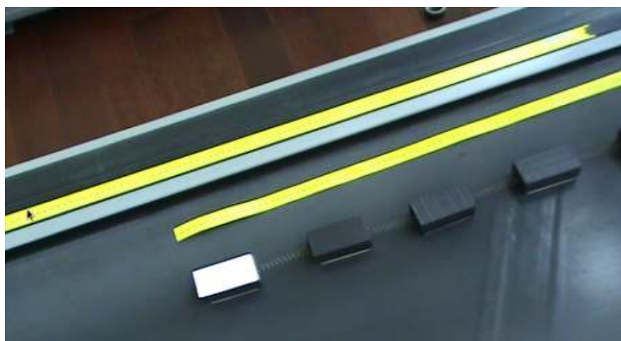
( V.1.ábra ): A rugó-tömb lánc a kísérletben. Futószalag.
