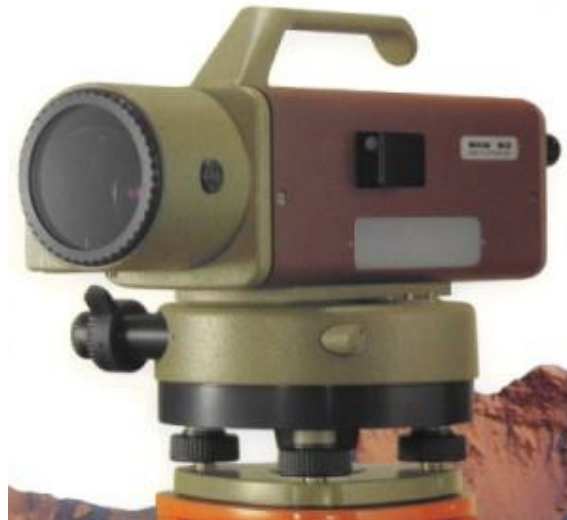
4-4. ábra a Leica N3 szabatos libellás szintezőkészlet
