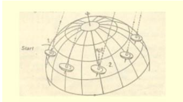
11-10. ábra A három szabadságfokú pörgettyű a Föld erőterében
