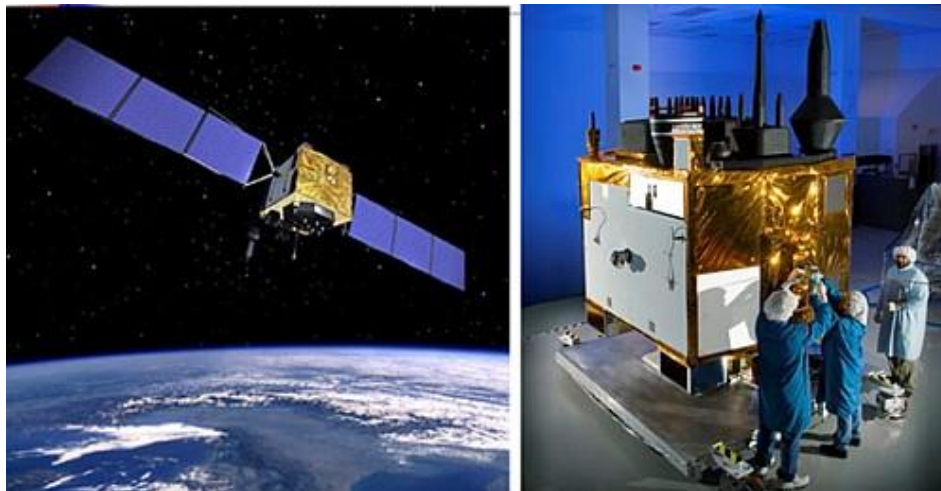
2-2. ábra. A GPS műholdak legújabb, II-F jelű típusa és szerelése
