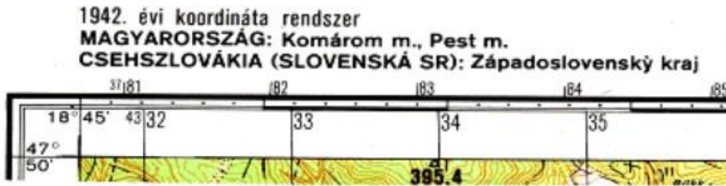
6-5. ábra Nemzetközi szelvényezésű térképszelvény ÉNY-i sarka
