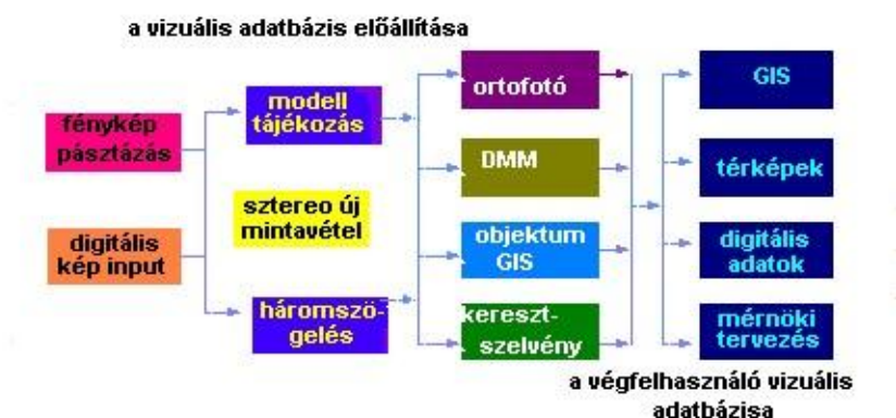
19.1. ábra A digitális fotogrammetria munkafolyamata, www.agt.bme.hu/tutor_h/terinfor/t32b.htm
