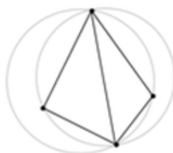
18. ábra Ez a háromszög háló nem megfelelő, mert az \alpha és a \gamma szögek összege nagyobb, mint 180 fok.
