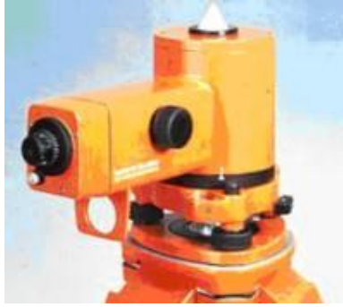
5-11. ábra Leica NL szabatos kompenzátoros nadírvetítő
