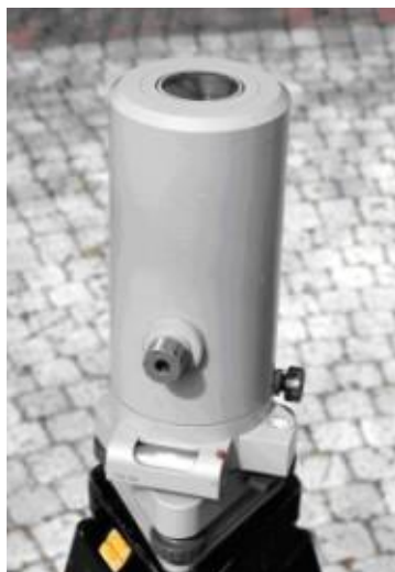
5 -9. ábra Zeiss PZL szabatos kompenzátoros vetítő
