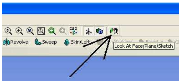
6.7. ábra: Nézet beállítása a vázlat síkjára merőlegesen
