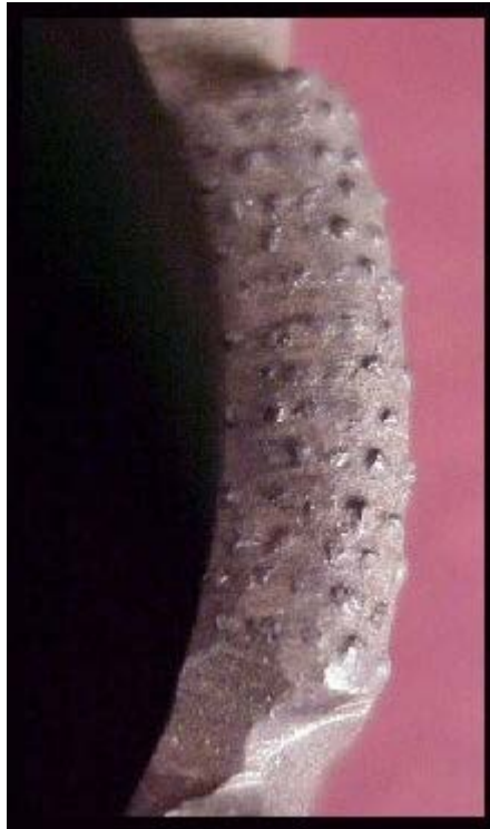
7.12 ábra: Gyémántkorona vágófelvéne durvaszemcsés gyémántból készült felületi felrakással
