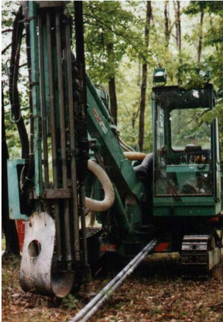
7.6 ábra: Önjáró forgatva-üteműkődő fúróberendezés, 40 m mélységkapacitással, Recsk déli terület aranyérc kutatása, 1996.
