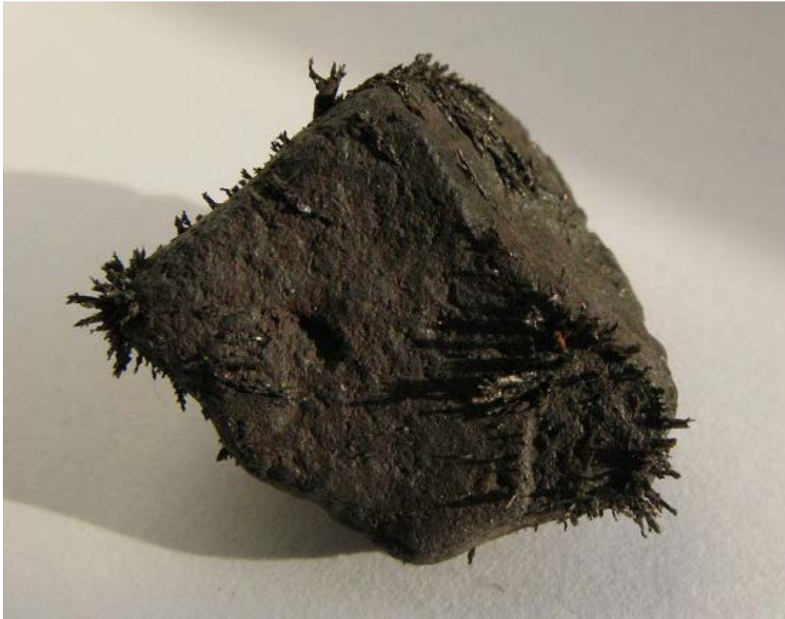
A ferromágneses magnetit magához vonzza a vasreszeléket
