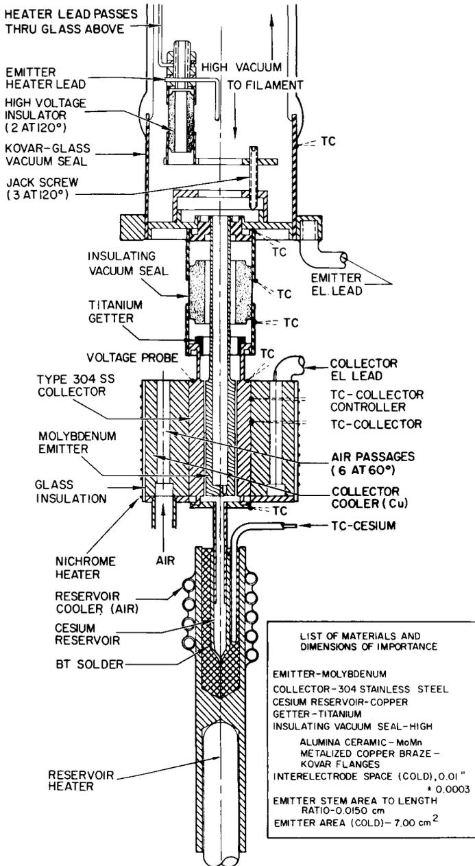
Fig. 1 Diode configuration
